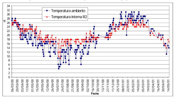
Gráfica 2: Temperatura del líquido afluente contra temperatura interna R2 (°C)
