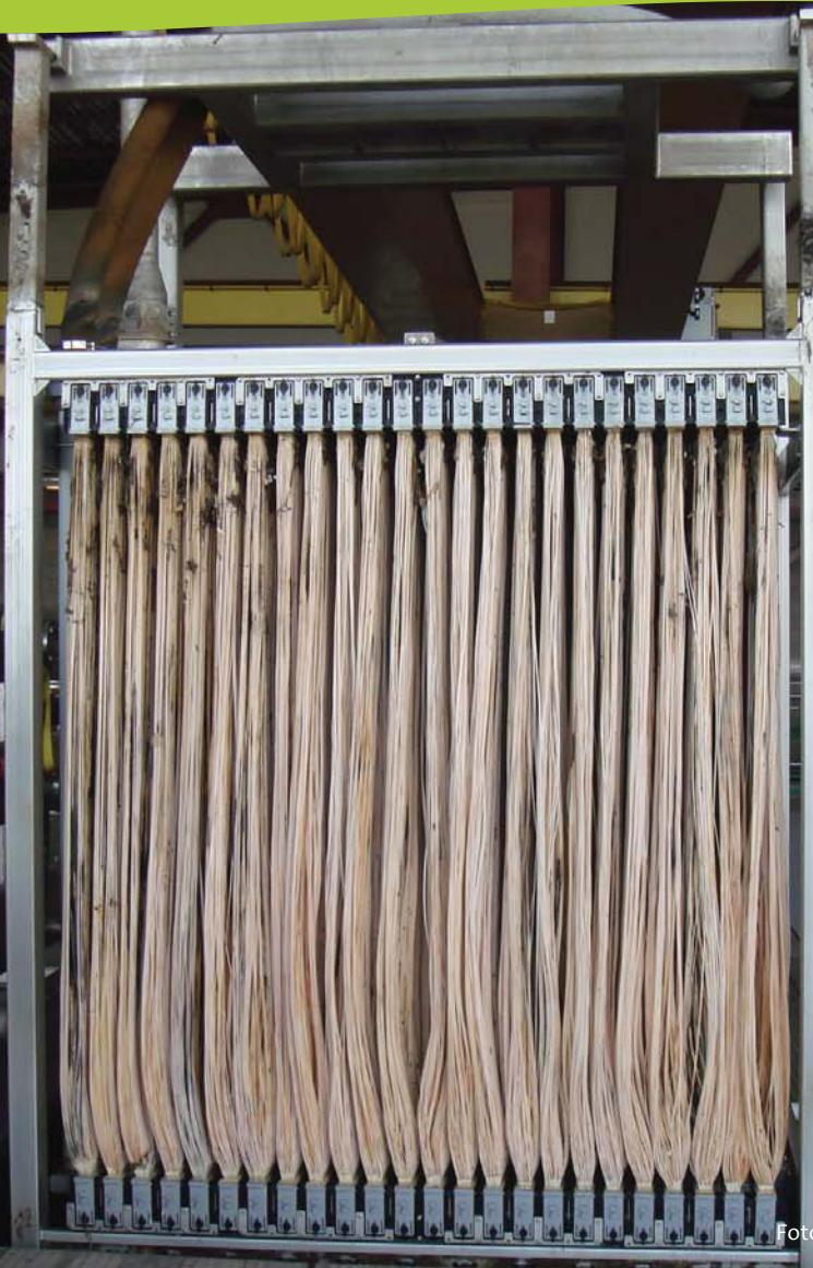
Foto: Módulo de membranas de biorreactor
