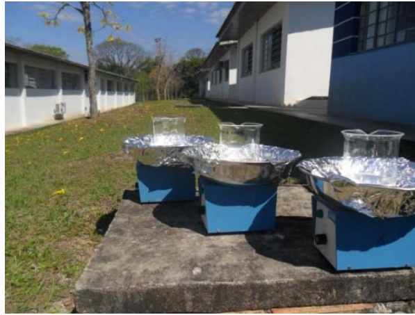
Figura 3. Reatores equipados com Coletor Solar parabólico revestido de alumínio.
