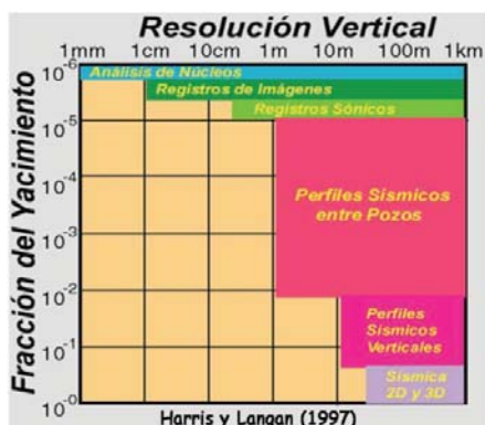
Figura 1. Variación de la resolución vertical asociada con las diferentes técnicas de exploración geofísica, con respecto a la fracción detectable de yacimientos de hidrocarburos (modificado de Harris y Langan, 1997).
