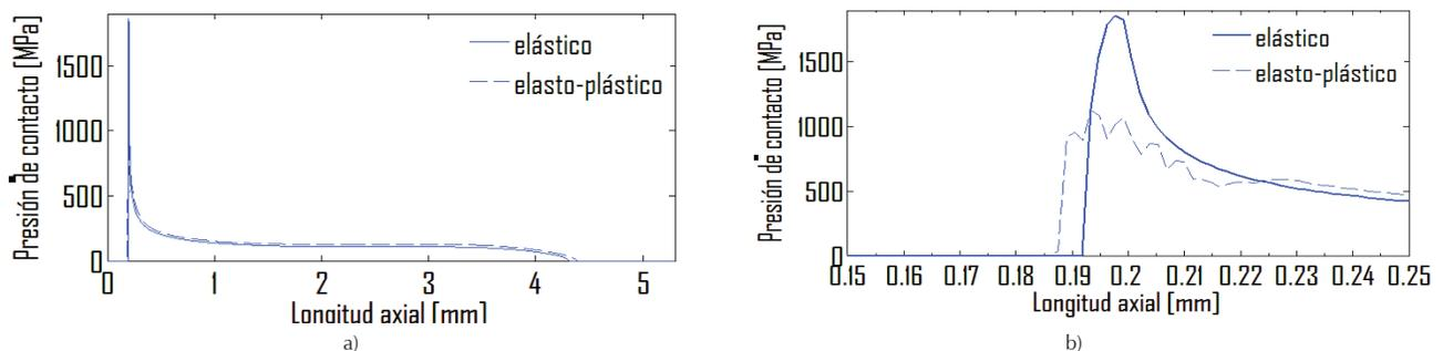
Figura 14. Presión de contacto usando material con comportamiento elasto-plástico para la geometría nominal con claro, donde: a) toda la longitud del aro y b) ampliación alrededor del radio  $R=0.2$  mm
