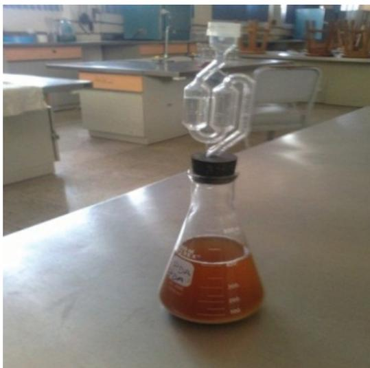
Figura 1. Fermentador acondicionado para producción de cerveza artesanal
