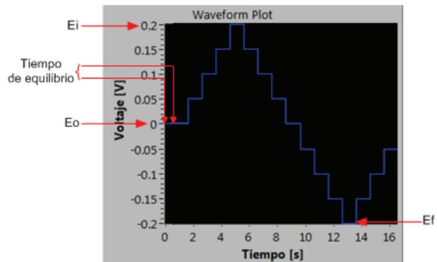
Figura 6b. Onda voltametría cíclica simulada
