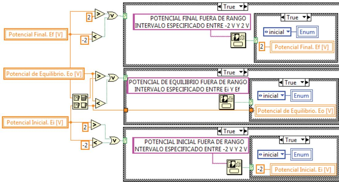
Figura. 12a. Parte de la máquina de estado
