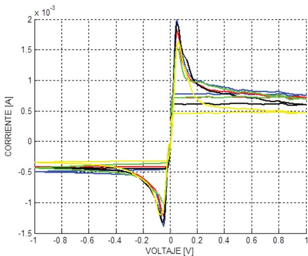
Figura 21. Voltamograma utilizando varios canales activos
