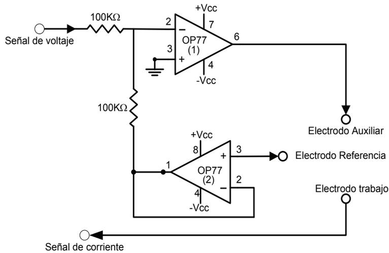
Figura 5. Multipotenciostato básico
