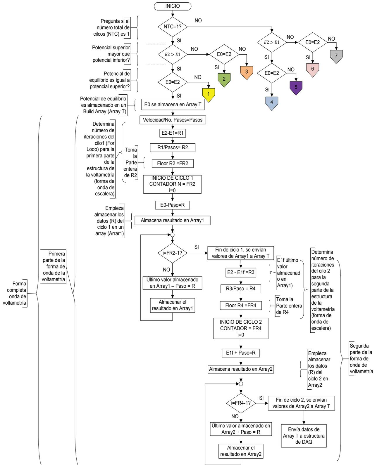
Figura 7. Parte del diagrama de flujo utilizado para la onda voltamétrica
