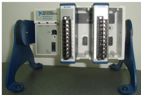
Figura 2. Módulos de adquisición de datos
