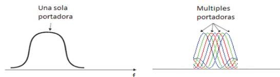
Figura 8. Comparación entre transmisión SC y multiportadora (OFDM)
