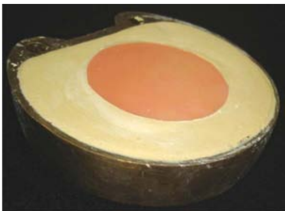
Figura 1. Enmullado del disco de cera, calibrado a las dimensiones requeridas ( 50 \pm 1 mm de diámetro y 0.5 \pm 0.1 mm de grosor).
