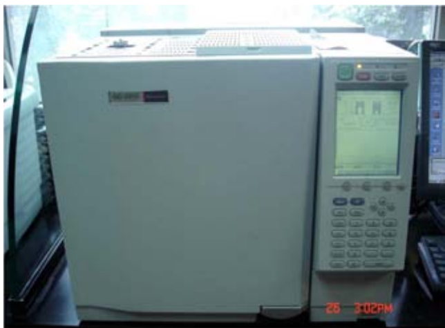
Figura 5. Cromatógrafo de gases GC-2010 Shimadzu® proporcionado por el Instituto de Investigaciones en Materiales de la UNAM.
