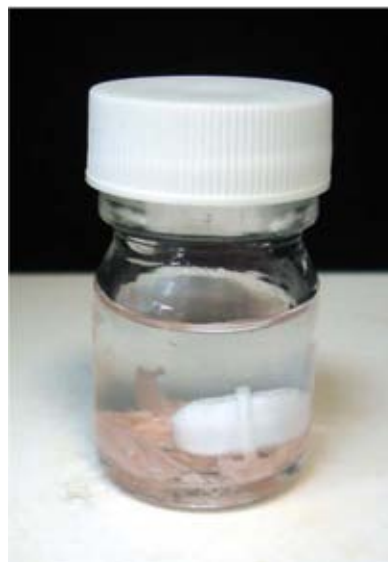
Figura 6. Frasco con la muestra pesada, se agrega THF como disolvente, y se coloca en una parrilla de agitación durante 72 \pm 2 horas.
