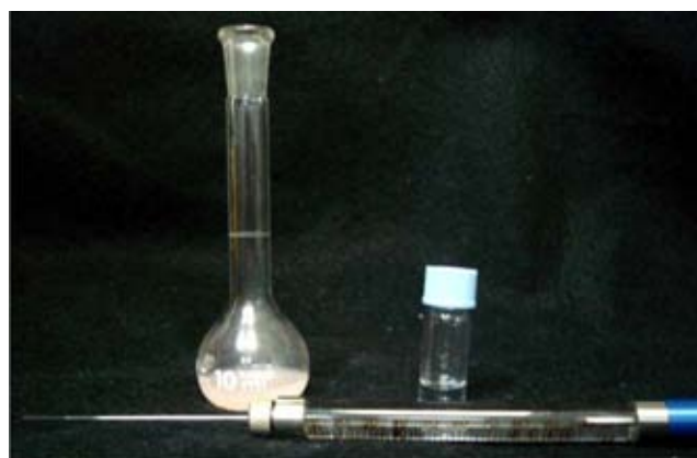
Figura 7. Matraz aforado de 10 mL, el cual contiene 2 mL de la solución muestra + 100 µL de Decano.
