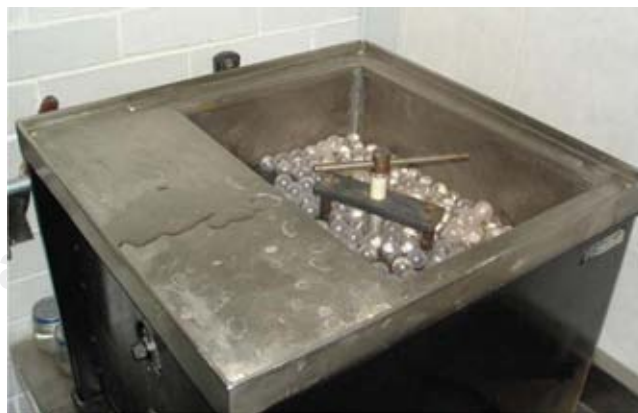
Figura 3. Una vez cerrada la mufla se introduce con todo y prensa a la unidad de curado. En los métodos de procesamiento M1, M2 y M3 después de los 15 minutos en la prensa hidráulica se cambiaron a la prensa manual marcada.
