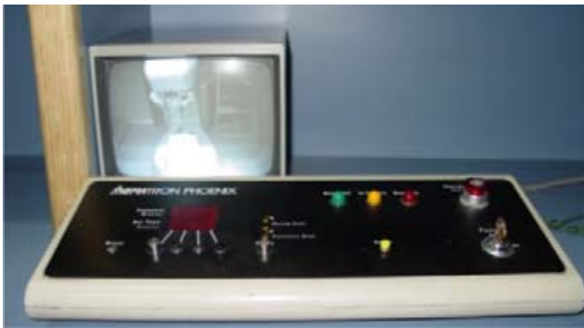
Figura 2. Panel de control del aparato de Telecobalto Theratron modelo Phoenix.
