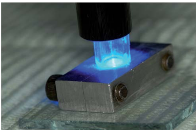
Figura 4. Fotocurado a 5 mm de distancia.
