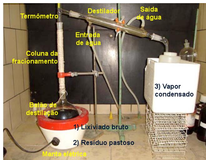
**Figura 02** – Aparato experimental dos ensaios em bancada
