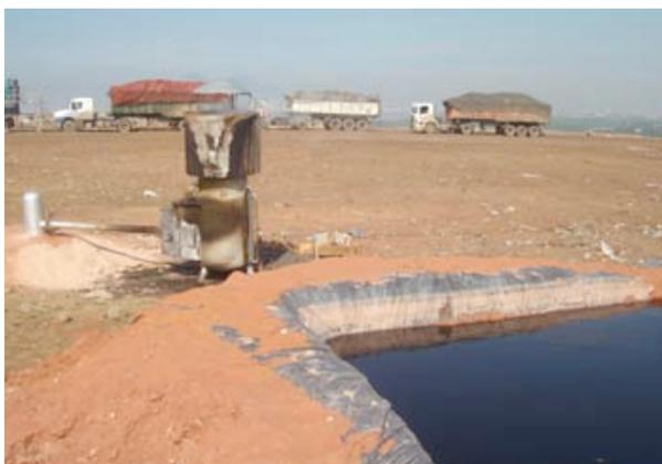
**Figura 03** – Evaporador Unitário e tanque de armazenamento do lixiviado
