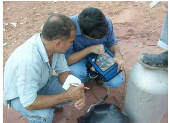
**Figura 06** – Medição de gás com o cromatógrafo portátil. **Figura 07** – Medição de gás com o GEM 2000.
