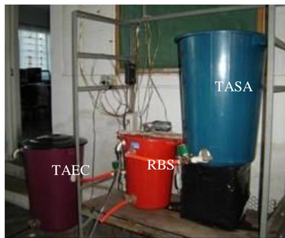
**Figura 2.** Sistema RBS com tanque de armazenamento de substrato amoniacal (TASA), reator RBS e o tanque de armazenamento do efluente clarificado (TAEC)
