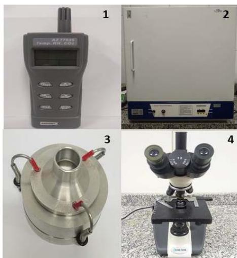
**Figura 3.** Aparatos instrumentais usados no monitoramento do conforto ambiental e da contaminação com fungos anemófilos nos diferentes setores das unidades hospitalares em estudo. 1: Analisador portátil de CO<sub>2</sub>, 2: Estufa microbológica, 3: Amostrador de bioaerossóis (impactador) e 4: Microscópio óptico. Fonte: *Elaboração própria.*
