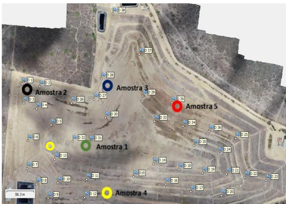
**Figura 3.** Localização dos drenos no aterro e pontos de retirada de amostra.
