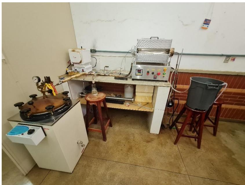
**Figura 3.** Reator empregado nos ensaios de pirólise.
