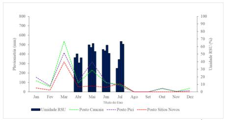
Figura 11. Relação entre a pluviosidade e os teores de umidade dos residuos aterrados na Área 2.
