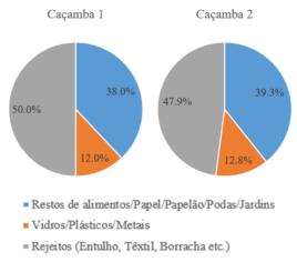
Figura 8. Composição gravimétrica dos RSU coletados pelas caçambas.
