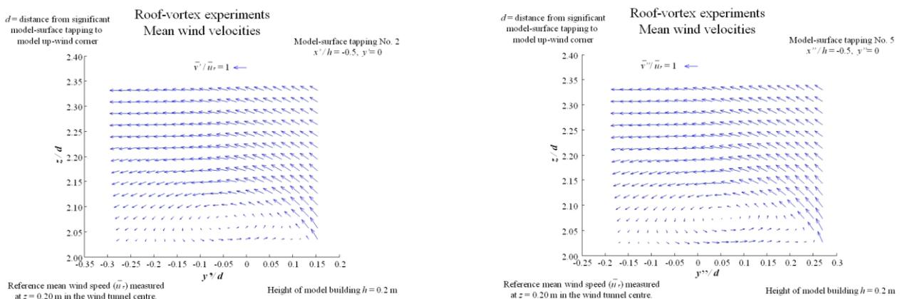
Figuras 8 y 9. Velocidades medias sobre el orificio para medir presiones Num. 2 (sobre el eje paralelo a  $y'$ ) y Num. 5 (sobre el eje paralelo  $y''$ )
