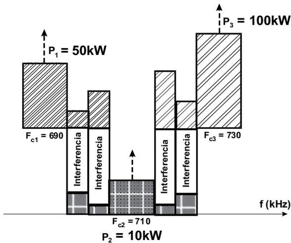
Figura 3. Interferencia de señales digitales entre estaciones adyacentes
