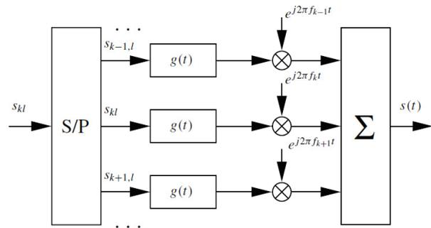
Figura 1. Diagrama de bloques del proceso OFDM (Schulze, 2005)
