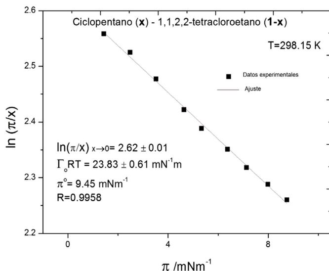
Figura 1. Sistema líquido-líquido que cumple con la ecuación de Volmer, expresión (33), en todo el intervalo de presión superficial y composición;  $\pi^0$  es la presión máxima de este sistema (Lam y Benson, 1970).
