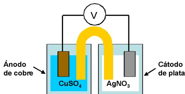
**Figura 2.** Esquema de la pila utilizada para determinar el valor de  $E^\circ$  de la reacción electroquímica en la pila II. Las soluciones a emplear en los compartimientos anódico y catódico son de concentración 1M.
