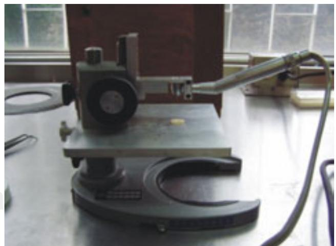
**Figura 1.** Aditamento para realizar las perforaciones en la furcación.
