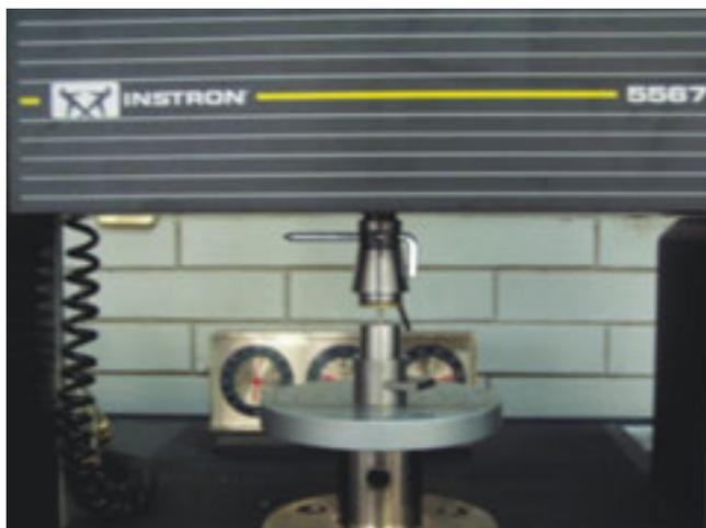
**Figura 3.** Máquina Instron aplicando carga a los especímenes.
